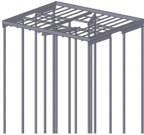
Le squelette support des charges du PH R+5 © ERCT
