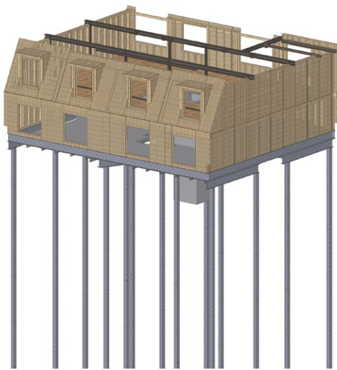
Le R+7 et la structure métallique support du R+8 © ERCT
