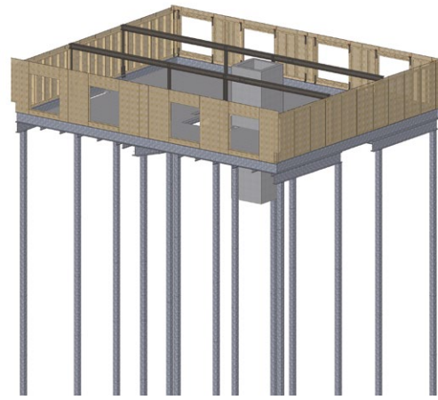
Le plancher de reprise, les murs bois du R+6, la structure métallique support du R+7 © ERCT
