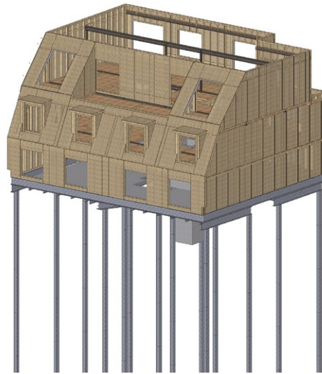
Les 3 niveaux « bois » et la structure métallique support de la terrasse © ERCT
